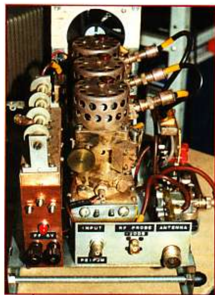
23 cm. eindtrap met 3 cavity's in cascade. Links op het chassis het filter
